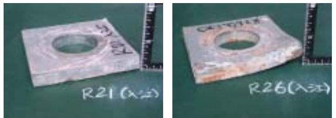
写真-4 定着端部の座金の变形
