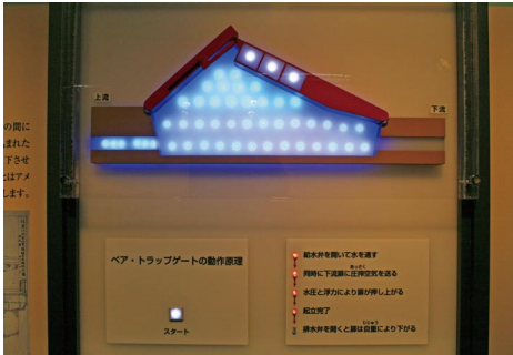
ベア・トラップゲートの原理模型
