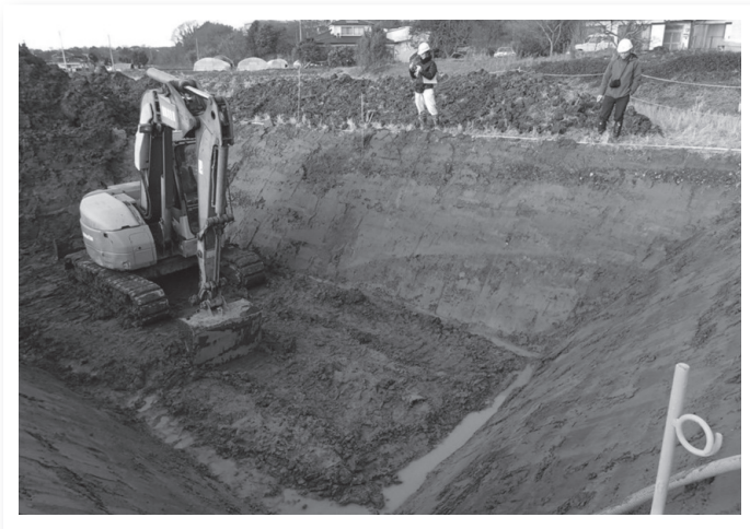
写真2 熊本県日奈久断層帯での掘削調査の様子 (提供：宮下由香里氏)
