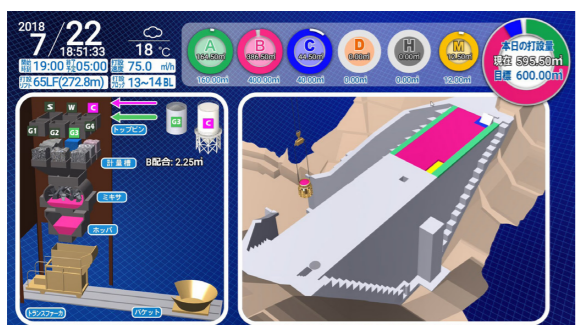
図2 ダムコンクリート総合管理画面
