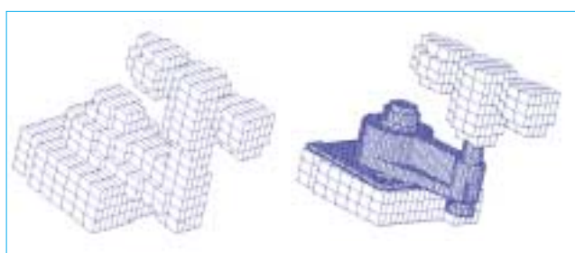
図-2 イメージベースの解析(有限被覆法) 左が一般的なボクセル分割による解析モデル、右が多重ボクセル分割による解析モデル
