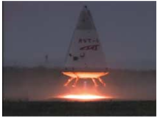
図-3 単型再使用宇宙機研究用の機体（稲谷（宇宙研）らによる）
