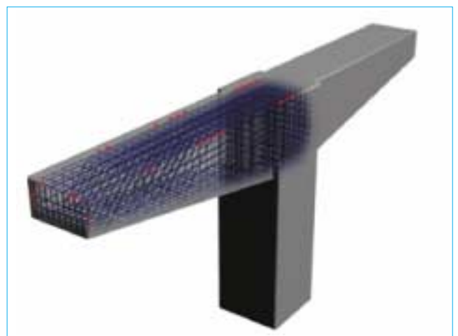
図-1 鉄筋破断が生じた位置の例
