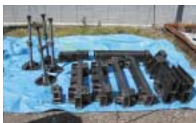
分解時 写真-7 組立式100 kN貫入装置
