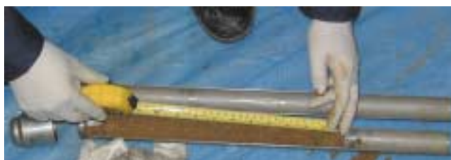
写真-3 プッシュインサンプラーによるサンプリング
