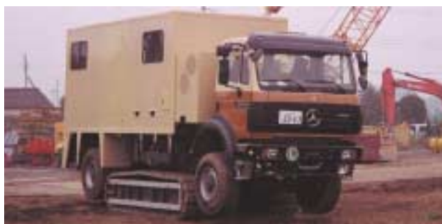
写真-5 トラック搭載式200 kN貫入装置
