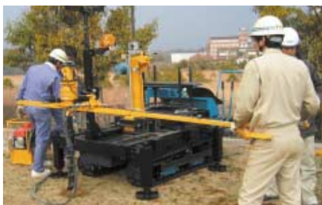
写真-6 クローラ搭載式100 kN貫入装置
