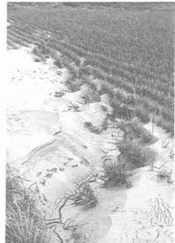
写真 6.2.7 (後志別別川) 堤内地の噴砂状況
