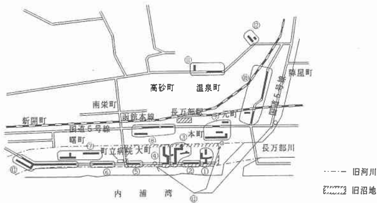
図 11.1.8 長万部町における下水道被害箇所
