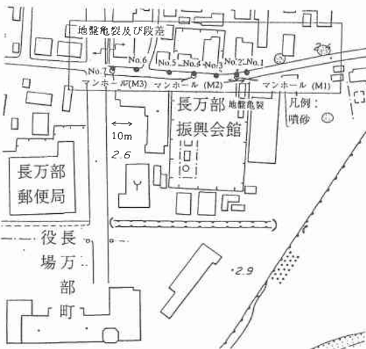
図 11.3.3 調査地点 1 における地盤変状等の状況 8)
