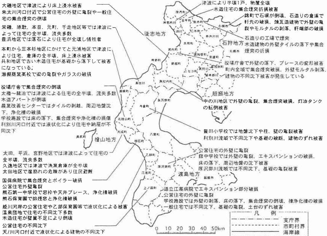
図 12.3.1 松山・後志支庁管内被害状況図
