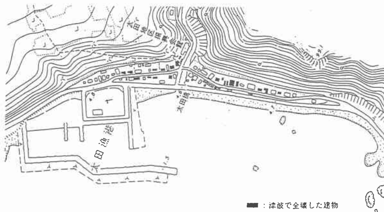
図 12.3.2 津波による被災状況（大成町太田地区） 25)
