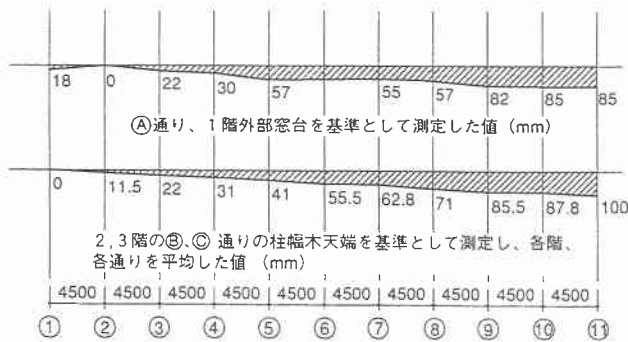
図 12.2.5 青苗小学校校舎杭基礎の被害状況
