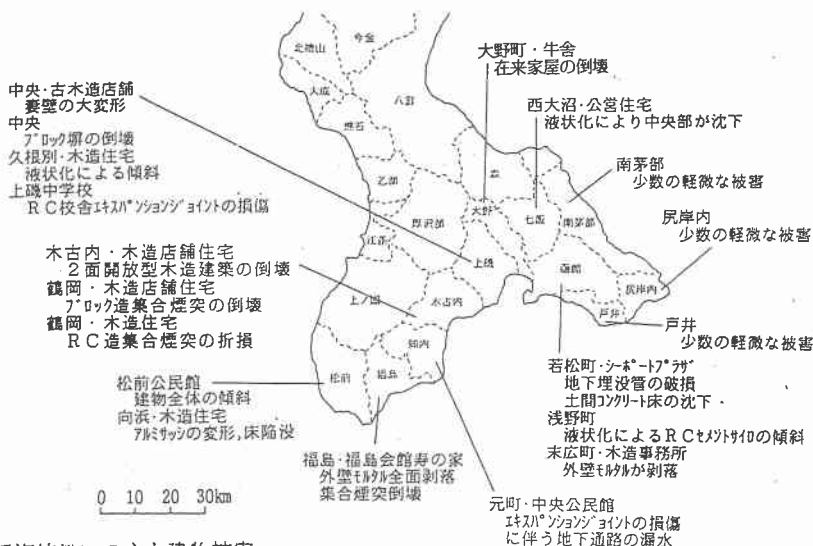
図 12.4.1 津軽海峡沿いの主な建物被害
