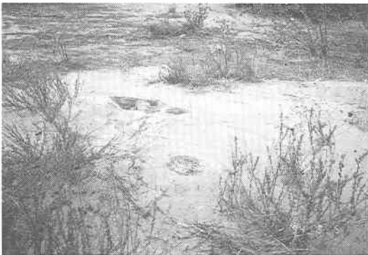
写真 7.3.9 サンフェルナンド下ダム法先付近の噴砂 (東京工大 川島一彦教授より提供)
