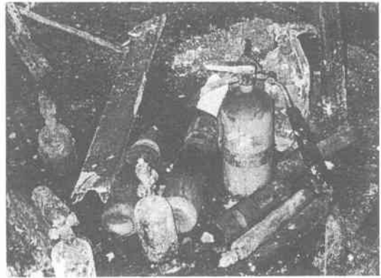
写真 10.2.6 破裂したガスボンベ（ノースリッジ大学）
