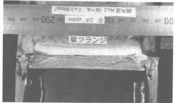
写真-5. 4. 6 破断面 (R=0mm 試験体, \delta = \pm 80\text{mm} )
