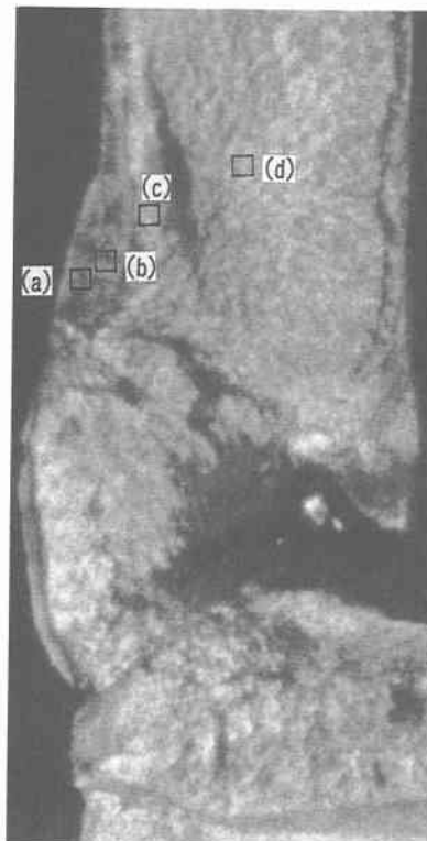
(e) 亀裂発生位置付近の破面
