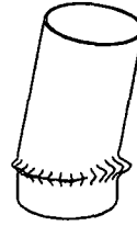
円形断面橋脚における変形の集中, 進展に伴う傾斜, 割れ
