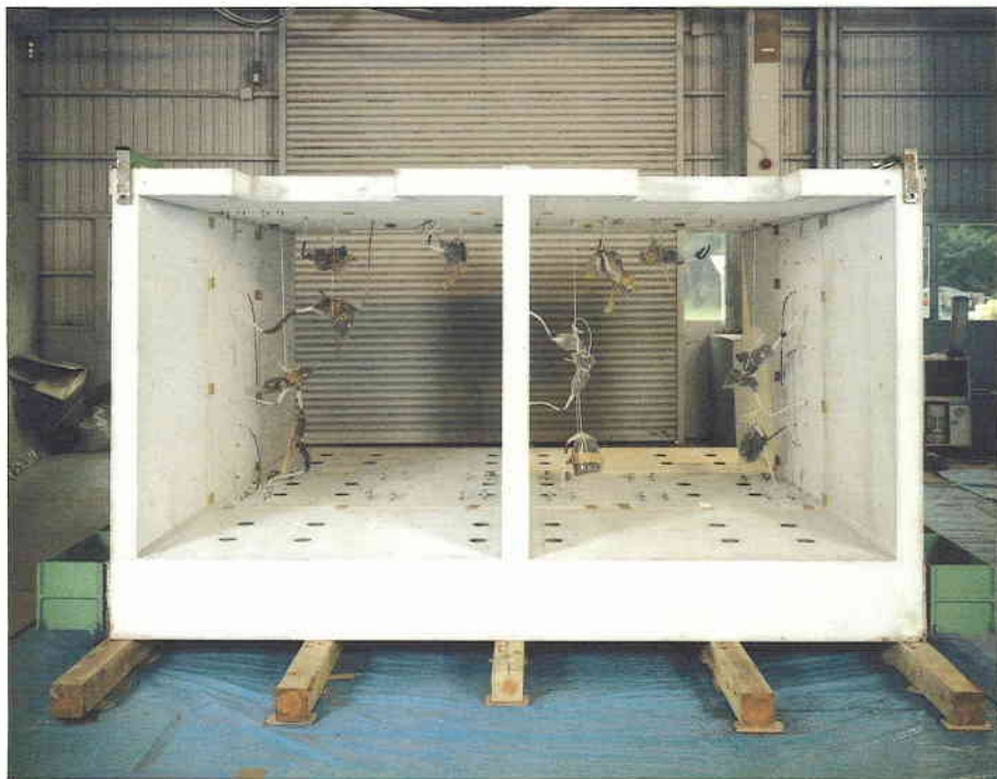
ボックスラーメン構造試験体
