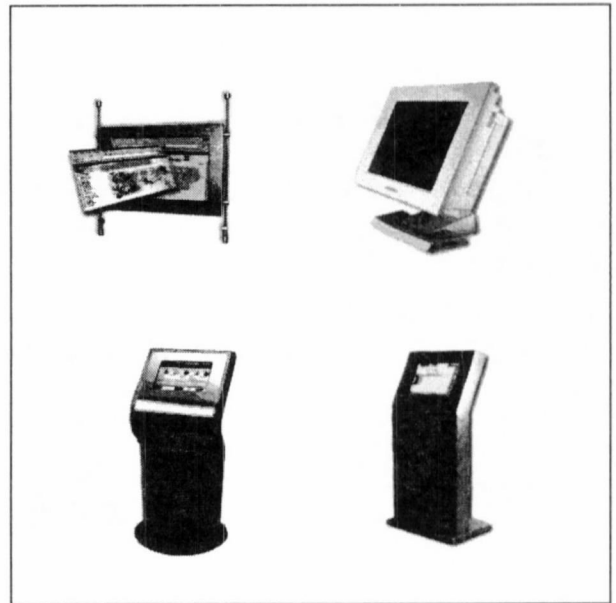
図-7: 晴海トリトンスクエア内の企業、テナントに対しては端末をハブとして各種のメディアで情報を配信し、外来者に対しては図のキオスクによって双方向な情報提供をする。
