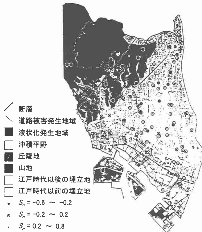
図 3.7.2-3 西宮市における液状化分布図 (阪神・淡路大震災調査報告編集委員会 建築編-4 1998)
