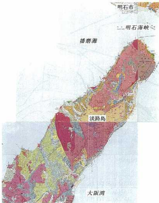
図-7 淡路島における建物被害分布と地質図 (赤は全壊、黄は半壊、緑は一部損壊)
