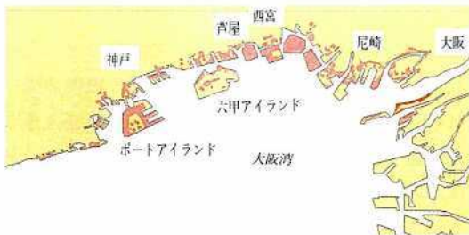
図-13 配電設備支持物の被害分布（折損・倒壊）
