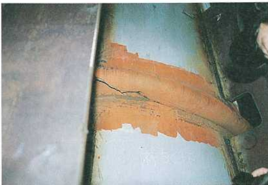
写真-9 低サイクル疲労の例1
