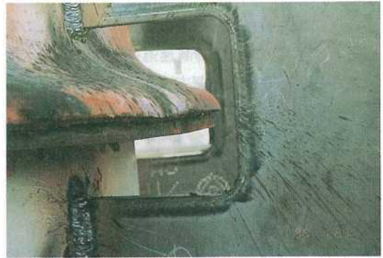
写真-10 低サイクル疲労の例2
