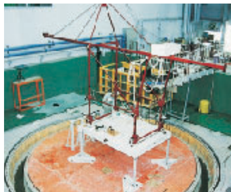
写真-2 1/15縮尺模型振動実験（棧橋とガントリークレーンの連成解析へ）
