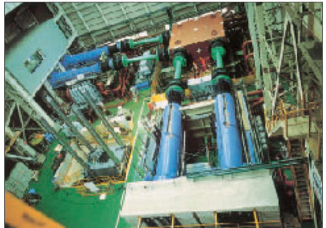
図-2 6 m × 6 mの模擬震動台を使った要素技術の確認実験
