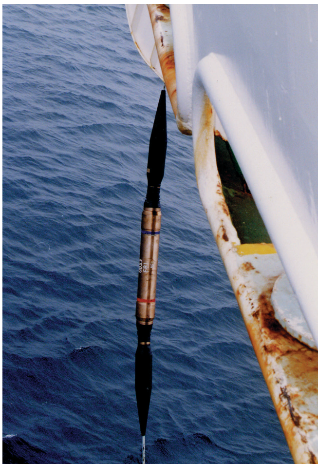
写真-1 海中に突入直前の地震計の外観（両端から光ケーブルがでている）
