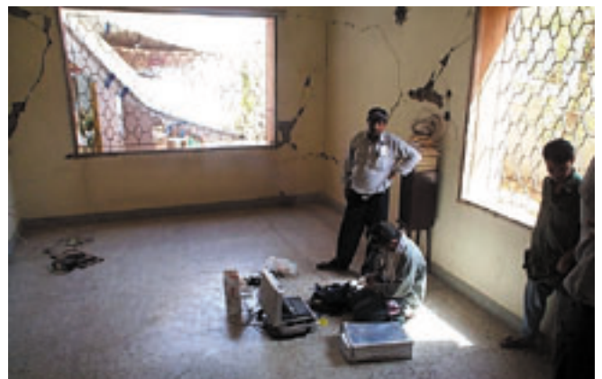
写真-10 ブジ市内の乳児院での微動計測
