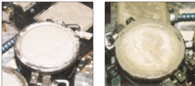
高流動コンクリート (膨張材有り) 普通コンクリート 写真-2 加振開始数時間後のブリージング発生状況
