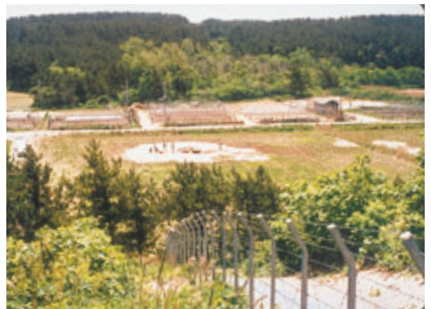
写真-2 車力村富池で発生した巨大噴砂
