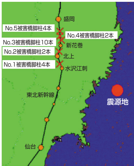
図-4 新幹線高架橋の被害位置
