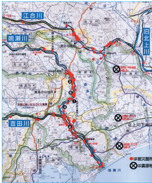
図-4 河川堤防被災位置（国土交通省東北地方整備局）
