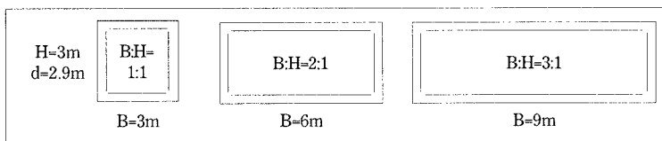
図-1 B/Hを変えた断面形状
