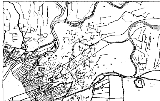
図-2 大阪市北部地区の配水管被害と旧地形
