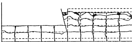
図 2: 加振後の地盤の最終状態
