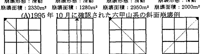
(B)t1時刻のTMデータを用いて検出された六甲山系の斜面崩壊例各画素のB/W濃淡: 崩壊面積占有率 (黒いほど崩壊面積大), 矢印: 崩壊の向き
