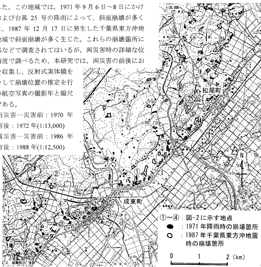
図-1 1971年降雨時および1987年千葉県東方沖地震時の斜面崩壊箇所
