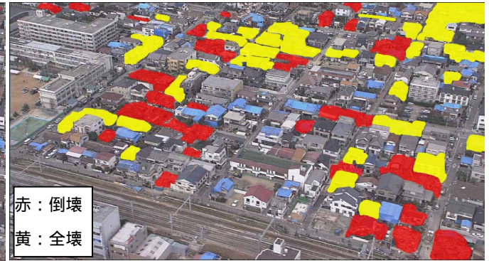
図-6 建物被害地上調査データ、空撮画像目視判読に基づく被害建物の分布（地域 B）
