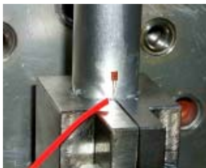
図2．ポールの歪み測定
