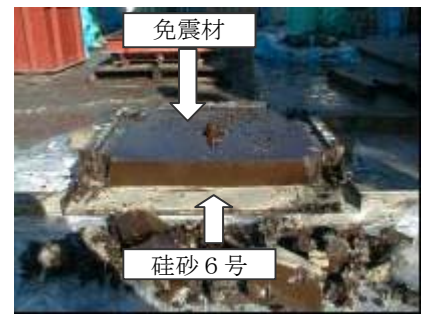
写真2 No.4 注入後断面
