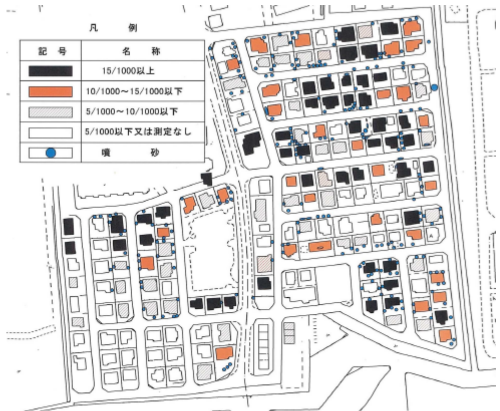
図1 噴砂発生地点と家屋の傾斜角の分布
