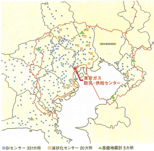
図-2 SIGNALのモニタリング用地震センサー
