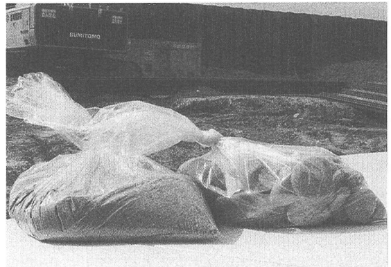
写真-2 第1地点で地震直後に採取した噴砂と噴砂中に散在していた円礫
