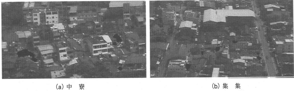
図-6 台湾地震の空撮画像に対して、兵庫県南部地震の閾値を用いた場合の建物被害地域の推定結果。テクスチャ解析の際、(a)中寮、(b)集集ともに画像全体にわたって83x83画素のウィンドウを用いた。
