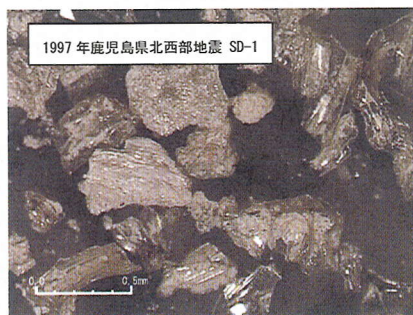
写真-3 1997年鹿児島県北西部地震において海岸埋立地以外で生じた噴砂の内細粒側の噴砂の顕微鏡写真
