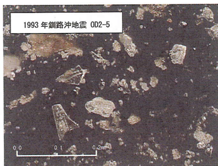
写真-1 1993年釧路沖地震で採取した最も細粒な噴砂の顕微鏡写真
