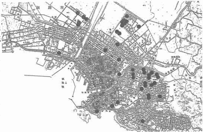
図-3 釧路沖地震における下水道管渠の被害箇所
