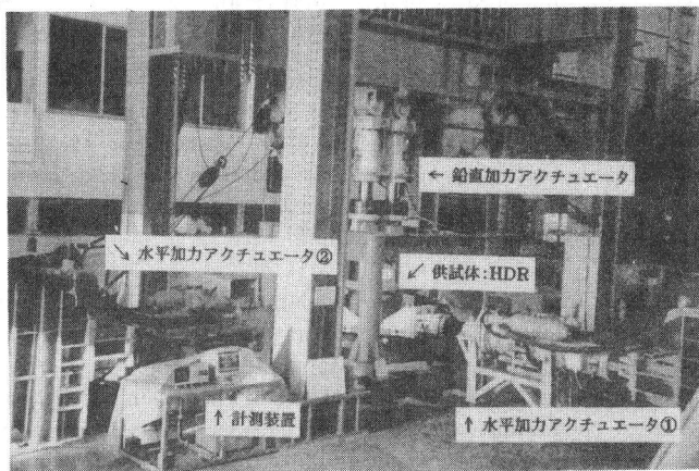
写真-1 ハイブリッド地震応答解析実験 実験装置・状況
