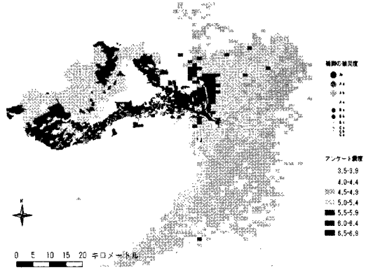
図1 阪神高速道路の各橋脚の被災度とアンケート震度
