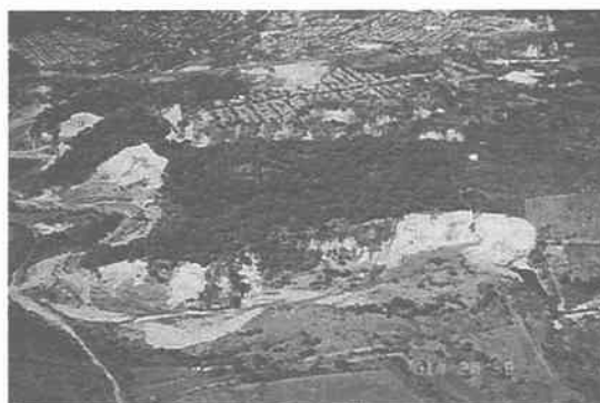
写真-6 Lago de Ilopango におけるしらす斜面崩壊
