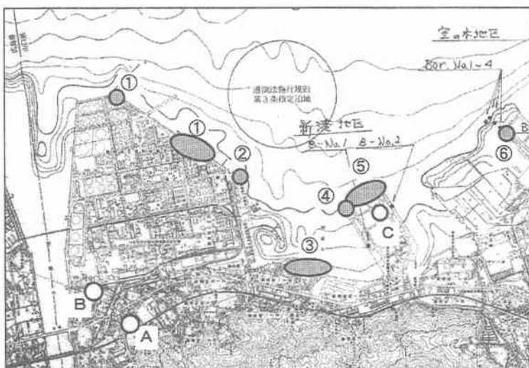
図-1 港湾施設及び液状化の被害箇所
