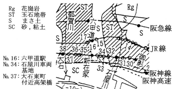
図6 地盤状態図と被害位置(文献13)に追加) 8)
