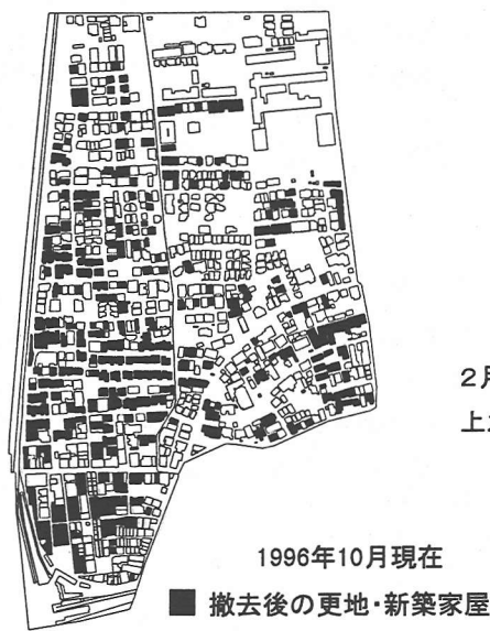
図6 北口町・高木西町の家屋撤去・新築状況
