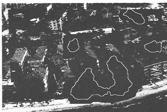
図-3 ギョルジュク画像の教師データを用いた最尤分類法による推定建物被害分布。白曲線内はRpx40%以上の領域を表す
