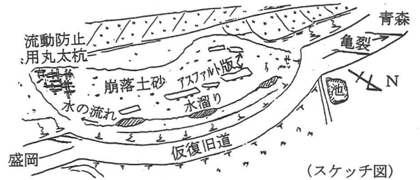
図7 目時地区盛土の崩壊状況 8)
