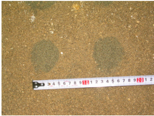
写真-2 改良杭の状況 (地中)
