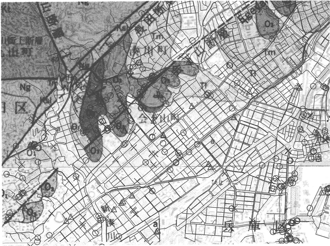
図2：会下山断層周辺の配水管被害分布
